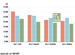
Uppvärmningskostnader med avkastningsgrad på 15 år för ett 120 m 2 hus, byggt enligt BBR.
